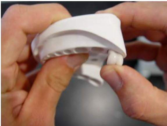
Abbildung 13: Einsetzen der Zähne in den Zahnträger
