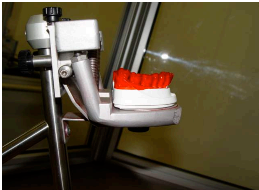
Abbildung 16: Modellträger mit fixiertem Zahnmodell
