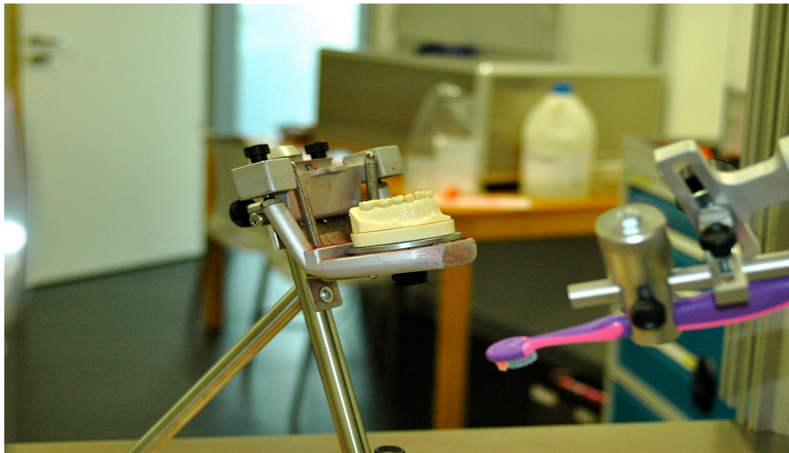
Abb. 4.3.: Der in den Putzroboter-Versuchsaufbau integrierte Modellträger mit eingesetztem Zahnträger (Wechselgebiss).
