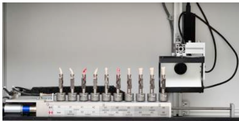
Abb.4.10.: Automatische Plaque Planimetrie (APP) (Gaengler et al. 2013)
