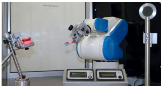
Abb.4.9.: 6-Achsen Industrie-Roboter FS 02N (Kawasaki, Kobe, Japan)
