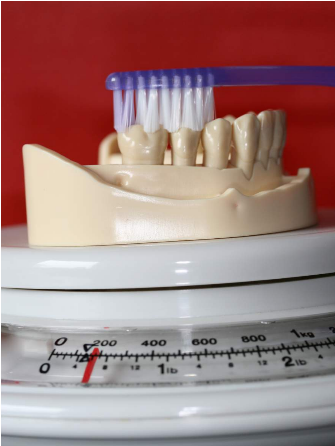
Abb.4.1.: Kalibrierung der Putzkraft auf 1,5 N mit der Kinderhandzahnbürste Signal Junior (Unilever, Hamburg, Deutschland) am Unterkiefermodell (Frasaco, Tettang, Deutschland) durch den Prüfarzt auf einer Waage.
