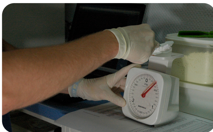
Abbildung 4.1 Kalibrierung der Anpresskraft auf 3,00 Newton
