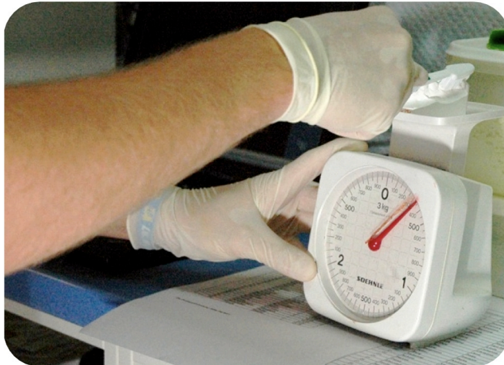
Abbildung 3.3: Kalibrierung des Anpressdrucks auf 3,5N
