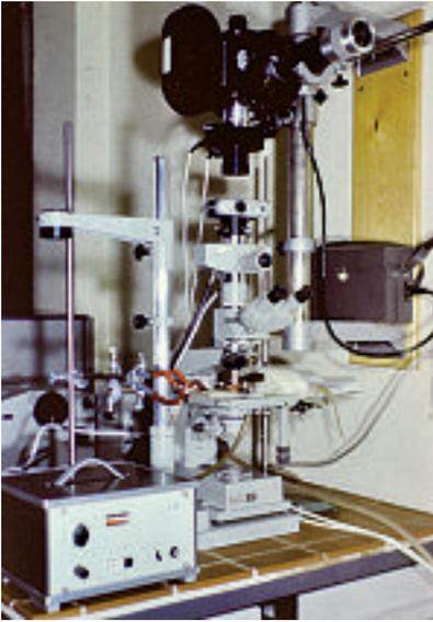
Abb. 1: Vitalmikroskopie-Einrichtung zur Untersuchung der vitalen Pulpa des Rattenschneidezahns
